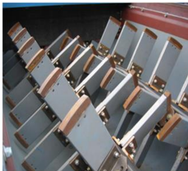
Рис. 31. Пример износостойкого исполнение лопастей горизонтального смесителя
