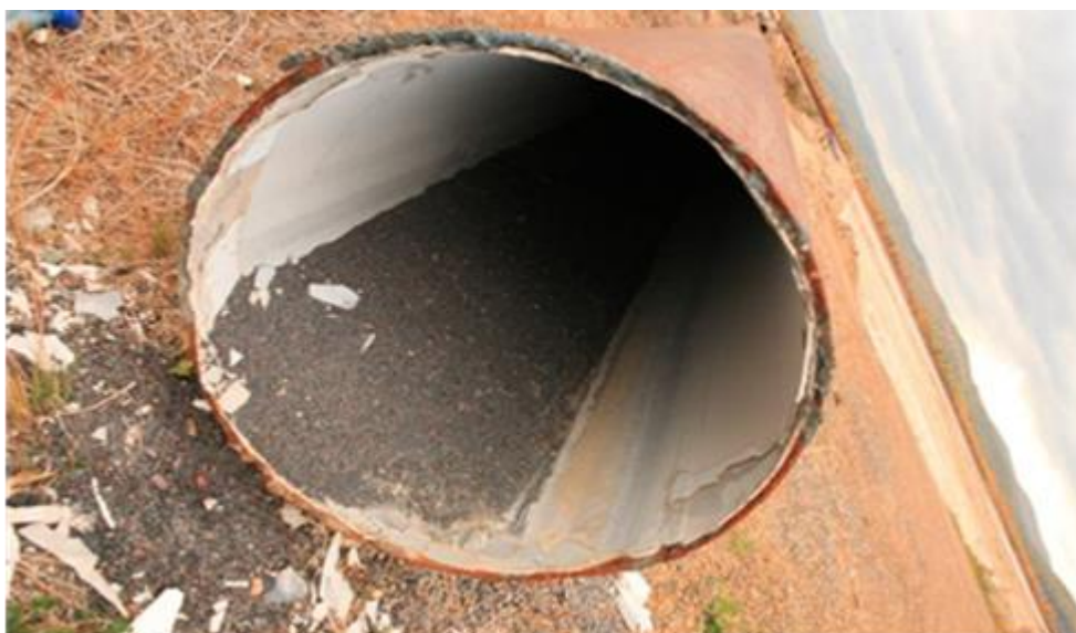
Рис. 15. Фрагмент трубопровода ГЗУ, развитие процесса зарастание сечения трубопроводов в результате отложения СаО.
