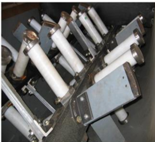
Рис. 31. Пример износостойкого исполнение лопастей горизонтального смесителя
